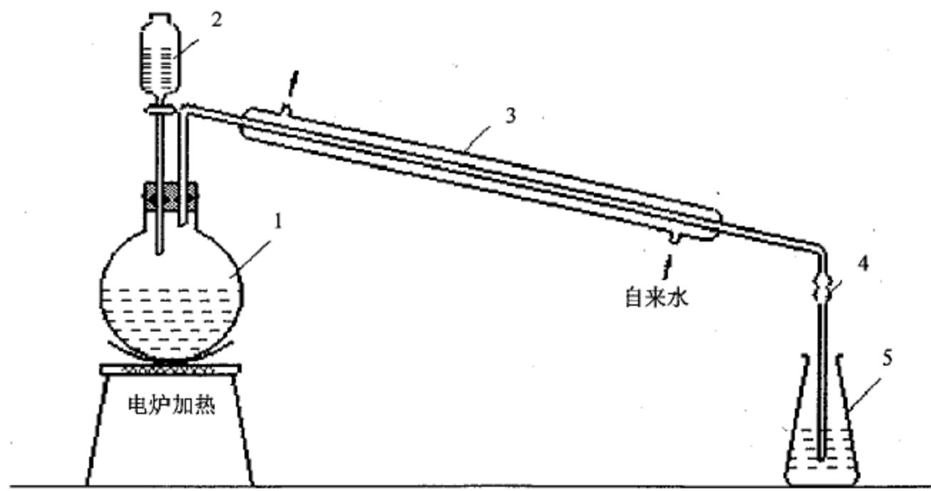
1—圆底烧瓶；2—加液漏斗；3—冷凝器；4—球形扩张管；5—三角烧瓶
